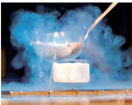
Ein mit flüssigem Stickstoff abgekühlter Supraleiter schwebt über einem Magneten
